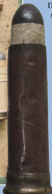
Патрон 11x50,5 мм к винтовке Комблена M1870
